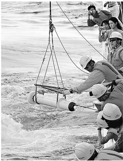
房総半島沖で船から観測機器のアルゴフロートを沈める研究者ら＝2008年10月ごろ（海洋研究開発機構提供）
