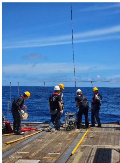
ブレーメン大学 MARUM 海洋環境科学センターから持ち込まれた現場型ろ過装置(in-situ pump)が、懸濁態有機物試料採取のため海底広域調査船「かいめい」から投入される。JAMSTEC©
